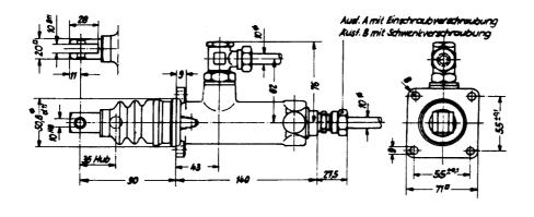
Kolben  $\varnothing = 31,75 \text{ mm } \varnothing$ Kolbenfl. = 7,9 cm<sup>2</sup>
